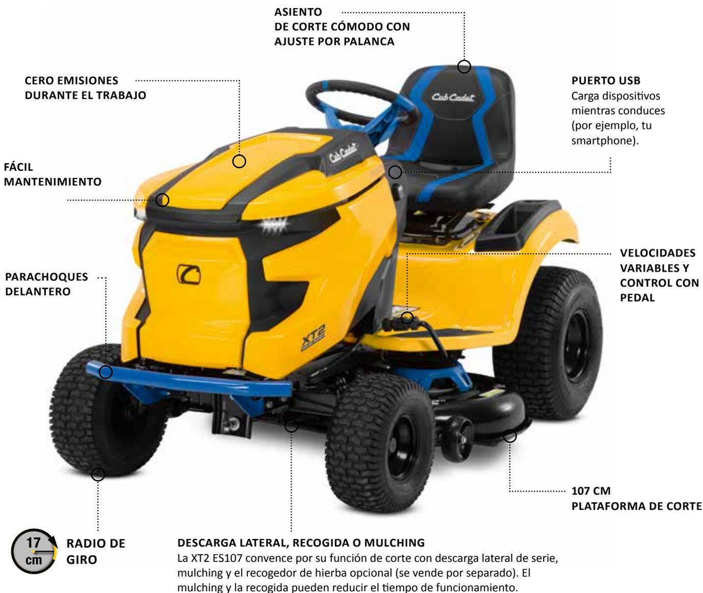
\*Por carga (corresponde a aprox. 14 000 m<sup>2</sup> de hierba) en las siguientes condiciones: carga de corte mínima, uso del modo de corte de descarga y posición de corte más alta a máxima velocidad con baterías Cub Cadet de 56 V MÁX.\*\* 60 Ah.
