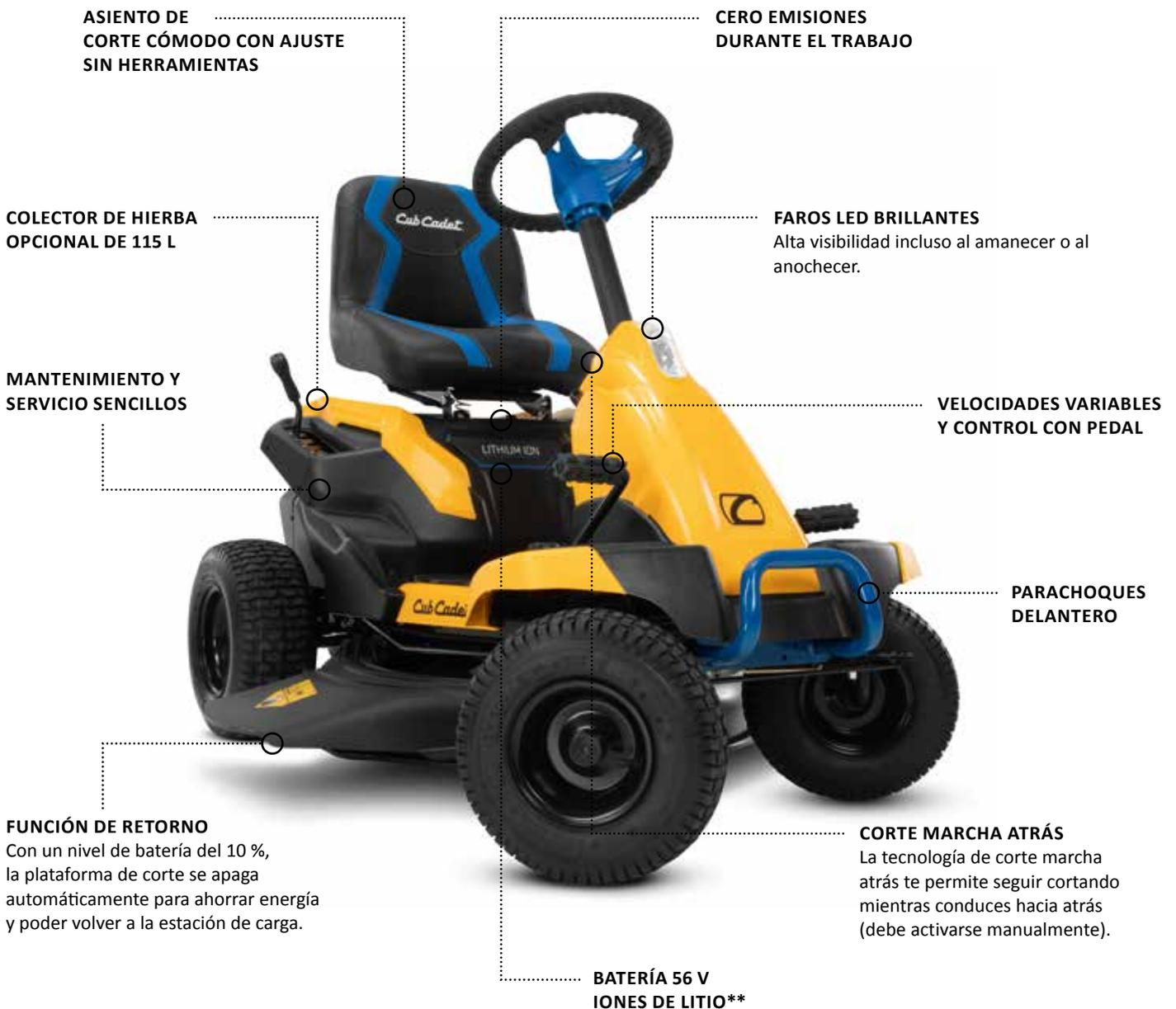
\*Por carga (corresponde a aprox. 4000 m<sup>2</sup> de hierba) en las siguientes condiciones: carga de corte mínima, uso del modo de corte de descarga y posición de corte más alta a máxima velocidad con baterías Cub Cadet de 56 V MÁX.\*\* 30 Ah.
